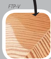
Древесина покрыта 2 слоями полиакрилового лака на водной основе
