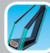
Стеклопакет L3: внешнее стекло – закаленное с легкоочищающимся покрытием, внутреннее – ламинированное с низкоэмиссионным покрытием, аргон, теплая дистанционная рамка TGI
